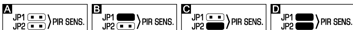
Obr. 2. Nastavení citlivosti detektoru (A – nízká citlivost, B a C – střední citlivost, D – vysoká citlivost) [■ – piny propojeny; □ – piny rozpojeny].
